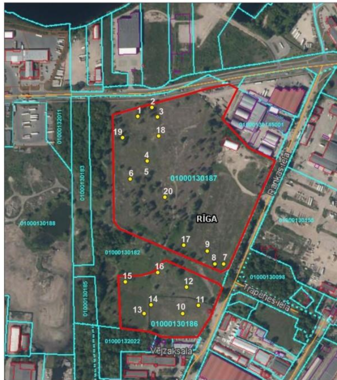
4.1.attēls. Izpētes izstrādņu izvietojuma plāns
