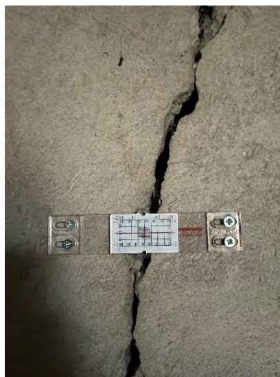
4.2.4.3. attēls. Plaisas monitoringa kontrolmarka
