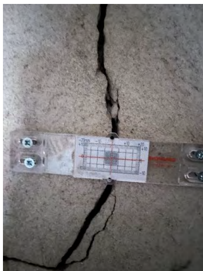
4.2.4.2. attēls. Plaisas monitoringa kontrolmarka
