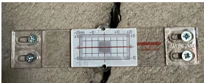
4.1.3.4. attēls. Plaisas monitoringa kontrolmarka
